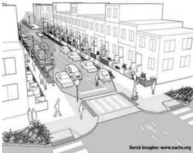
Figură 9-23 - Exemplu amenajare intersecții străzi tip „home-zone”
