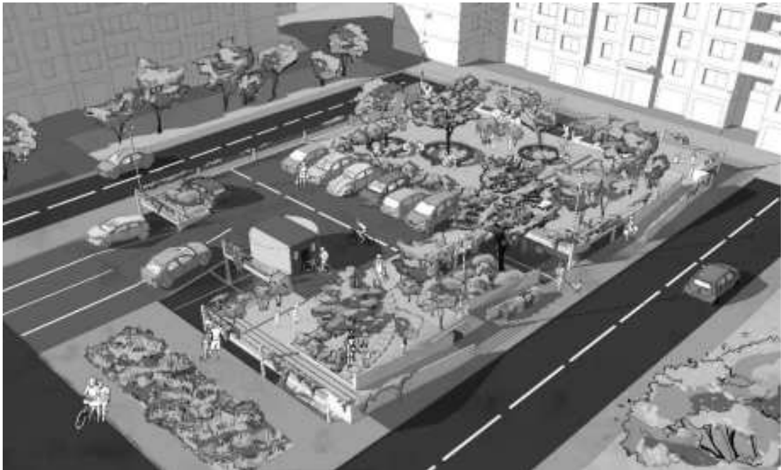
Figură 6-15 Mod de amenajare parcare 2 nivele cu nivelul superior axat pe spatiu verde si locuri de parcare vizitatori Sursa: Portofoliu consultant
